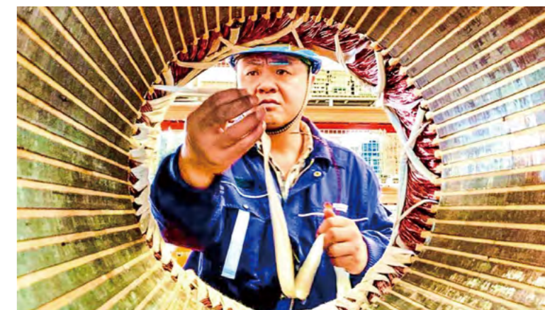
神东煤炭电气维修车间电工进行电机嵌线作业
