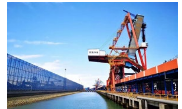
世界首个基于船岸数字孪生的智能装船系统
