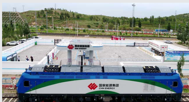
正在进行加氢作业的氢能源动力机车
